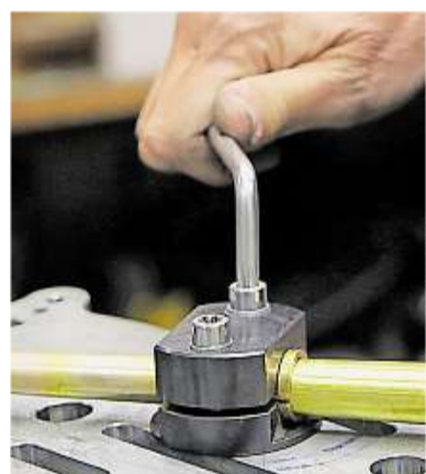
Das Schallstück wird zum Biegen eingespannt.
