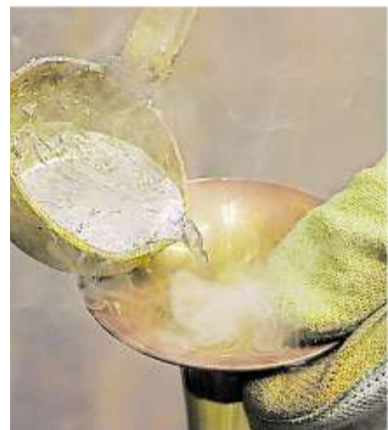
Das Blei wird in den Schallbecher gegossen. Gute Handschuhe sind dabei selbstverständlich.
