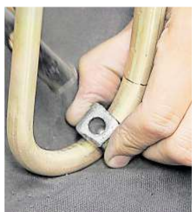
Das Material wird mit einem Auspocheisen geglättet.
