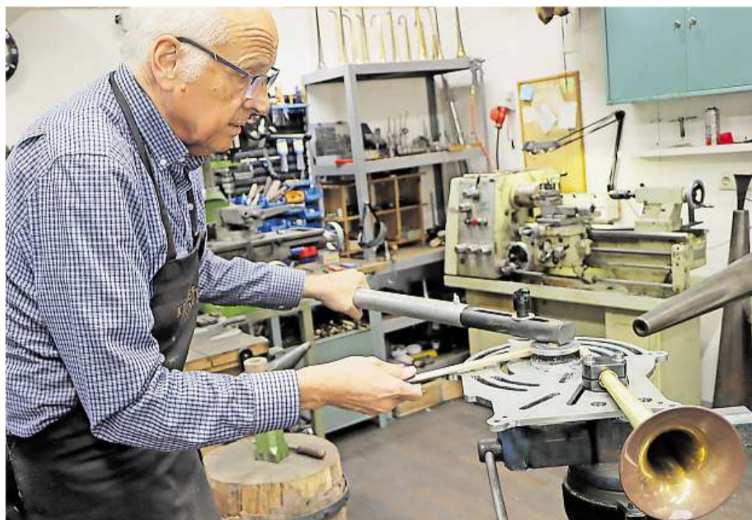
Die Form ist schon erkennbar: Franz-Josef Kröger biegt den Rohling mit viel Gefühl.
