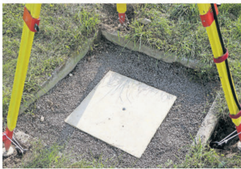
Die Einbohrung in der Mitte der Schraube ist das „präzise Zentrum“ des Vermessungspunktes, wie hier in Newel. FOTO: CHRISTINA BENTS
